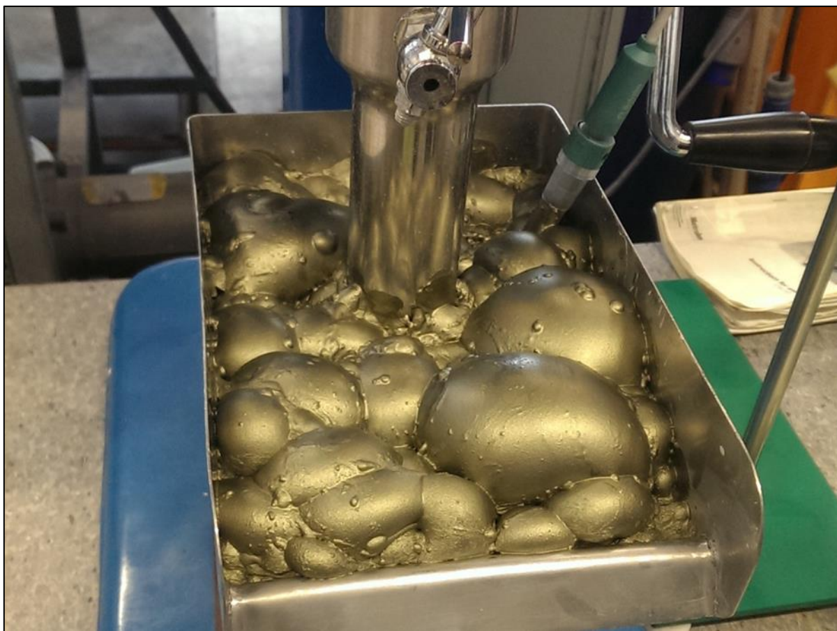
Figur 1: Xantat-flotasjon av kobbermalm fra Nussir utført ved NTNU (2015).
