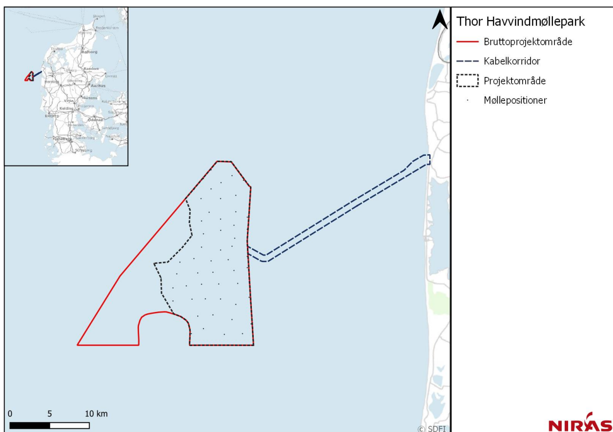
Figur 2.1: Afgrænsning af bruttoprojektområde, projektområde og kabelkorridor for Thor Havvindmøllepark. Positionerne af de 72 havvindmøller er ligeledes vist.
