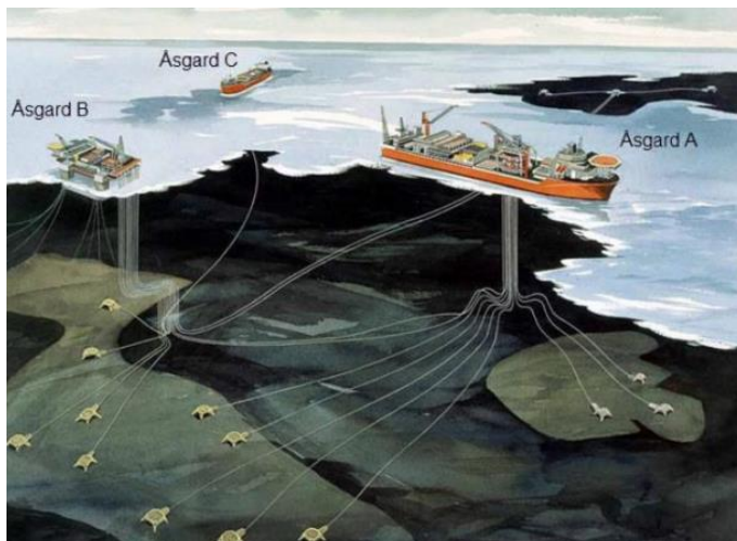
Figur 1: Åsgardfeltet bestående av produksjonsskipet Åsgard A, den halvt nedsenkbare plattformen Åsgard B og lagerskipet Åsgard C
